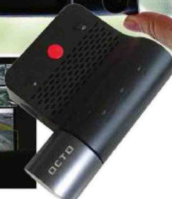
Occhi elettronici Da sinistra, in senso orario, la Smart Cam Octo Telematics con un secondo ingresso video, la centrale di controllo della Cav, che riceve le immagini raccolte dalle telecamere del sistema MobilEye, il modulo di registrazione di Webfleet Video.
